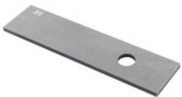
Procedura di base come segue: Misurare lo spessore della guida della slitta dell'arma; posizionare la barra di adattamento per slitta di dimensioni più vicine nel "way" del telaio; battere leggermente la guida del telaio con un martello leggero per ridurre lo spazio dei "way" fino a farlo corrispondere allo spessore della guida della slitta. Istruzioni complete incluse.
