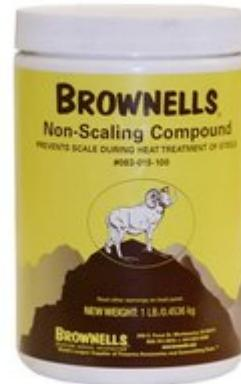
Spart Stunden beim Polieren, Schleifen und Formen - Teile können vor der Wärmebehandlung maßgenau hergestellt werden, ohne dass Maßänderungen durch Zunderbildung, Lochfraß oder Entkohlungsverlust zu befürchten sind. Extrem einfach zu bedienen - sowohl zum Härteln als auch zum Glühen. Erhitzen Sie das Werkstück auf ca. 13 ° C (500 ° F), beschichten Sie es mit dem trockenen Pulver, beenden Sie das Erhitzen auf Temperatur und kühlen Sie es nach Bedarf ab. Teile werden in kochendem Wasser gereinigt.
