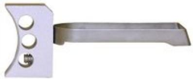
SPECIFICHE: grilletto in alluminio, anodizzato argento; supporto in acciaio inossidabile lucido. Grilletto - 1/4" (6,3 mm) di larghezza, 15/16" (23,8 mm) di altezza. Lunghezza totale misurata dal centro del grilletto alla fine del supporto. Corto - 2,05" (5,2 cm) OAL. Lungo - 2,24" (5,7 cm) OAL. È necessaria una regolazione da parte di un armaiolo.
