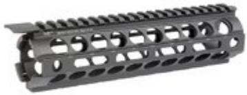
L'handguard è compatibile con M-LOK, lavorato in alluminio 6061, presenta una finitura anodizzata nera di alta qualità ed è completamente realizzato negli USA. Il design a due pezzi dell'handguard Free-Float AR-15 della Midwest Industries è disponibile in configurazioni carbine, mid-length e rifle-length e viene fornito con quattro prese per ganci a sgancio rapido per il trasporto.
