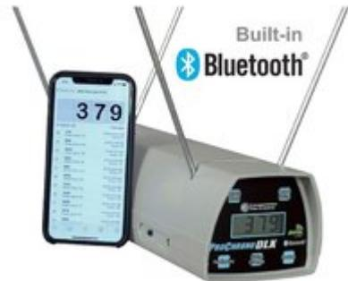
Die ProChrono DLX funktioniert nach dem Prinzip der Zeitmessung für den Weg, den ein Projektil vom ersten Sensorelement zum zweiten Sensorelement zurücklegt. Die intern im Gehäuse montierten Sensoren überwachen Licht durch die beiden rechteckigen Öffnungen oben am Gehäuse. Diese speziell entwickelten elektromechanischen Sensoren können die geringen Änderungen in der Lichtintensität erkennen, die auftreten, wenn ein Projektil Lichtstrahlen unterbricht.
