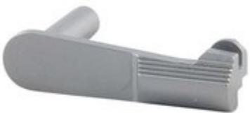
Disponible avec une goupille standard de .200" de diamètre ou une goupille surdimensionnée de .203" pour un ajustement personnalisé afin d'assurer le verrouillage le plus serré possible pour une précision maximale. Les deux tailles sont disponibles en acier au carbone 4140 bleu ou en acier inoxydable, tous deux avec une finition mate finement sablée. Des stries fines sur le pad offrent à votre doigt une prise sécurisée pour libérer le slide dès le premier essai.
