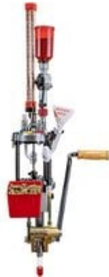
14 Numero di fori di montaggio per die: 5 Boccole di cambio rapido Breech Lock: Sì, 5 incluse Caratteristica di primer: Sì, senza restrizioni di marca di primer Tubo di raccolta primer usati: Sì Paese di origine: Orgogliosamente prodotto negli USA
