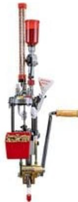
**SPEZIFIKATIONEN:** Maximale Gesamtlänge der Patrone: 3" automatisches Indizieren | 4" manuelles Indizieren Basismaterial: Stahl Säulenmaterial: Stahl Ram: Stahl Ramdurchmesser: Über 1" Verbindung: Stahl Werkzeugkopfmateriel: Stahl Akzeptierte Matrizen Größe: 7/8" x 14 Anzahl der Matrizenmontagelöcher: 5 Breech Lock Schnellwechselbuchsen: Ja, 5 enthalten Priming-Funktion: Ja, keine Markenbeschränkungen für Primer Gebrauchte Primer-Sammelrohr: Ja Herkunftsland: Stolz hergestellt in den USA
