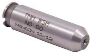
Präzisionsbearbeitung: Jedes Messgerät wird aus hochwertigem Stahl gefertigt und nach genauen SAAMI-Spezifikationen bearbeitet, um präzise und zuverlässige Messungen zu gewährleisten. Kaliberspezifität: Erhältlich in einer Vielzahl von Kalibern, bieten diese Messgeräte Vielseitigkeit für
