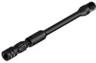
\* Les pistons Vepr et Salga nécessiteront un perçage à travers la tige après avoir vissé le piston dans le support, en raison des variations dans l'emplacement de l'encliquetage. Ces tiges sont phosphatées au lieu d'être nitruées pour permettre un perçage facile.\*
